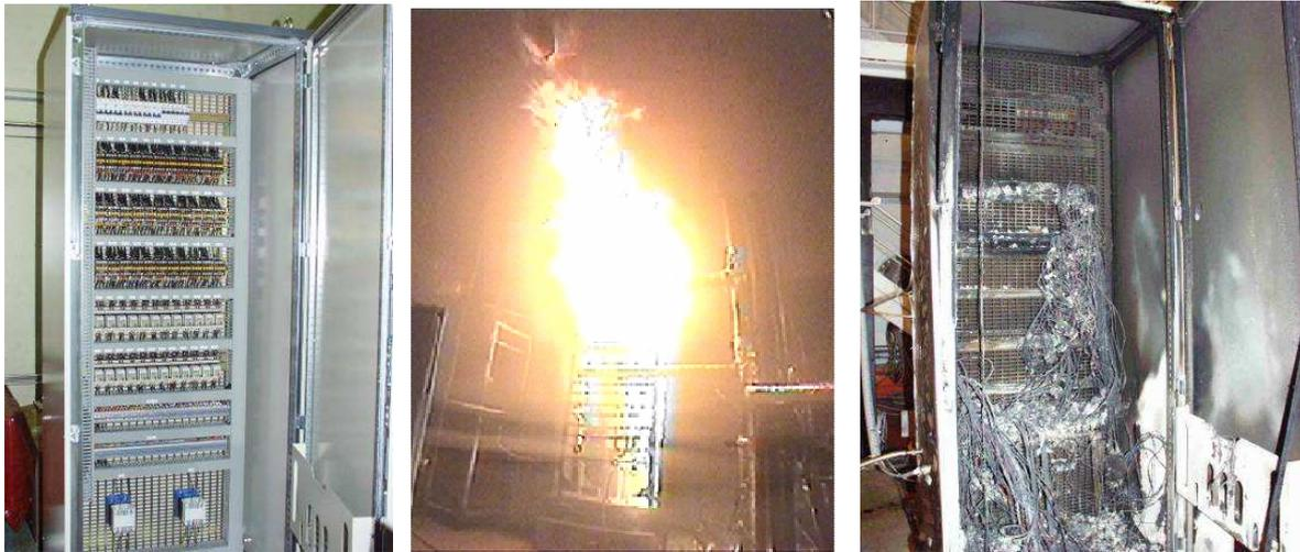
Figure 7 : Armoire électrique avant, pendant et après combustion
