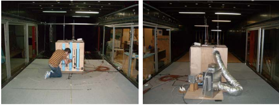
Figure 2 : Dispositif expérimental en soufflerie, face au vent (a), et face sous le vent (b)
