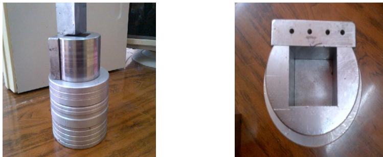
Figure 2: Image du moule utilisé pour la fabrication des pastilles de 40x40x4 mm 3
