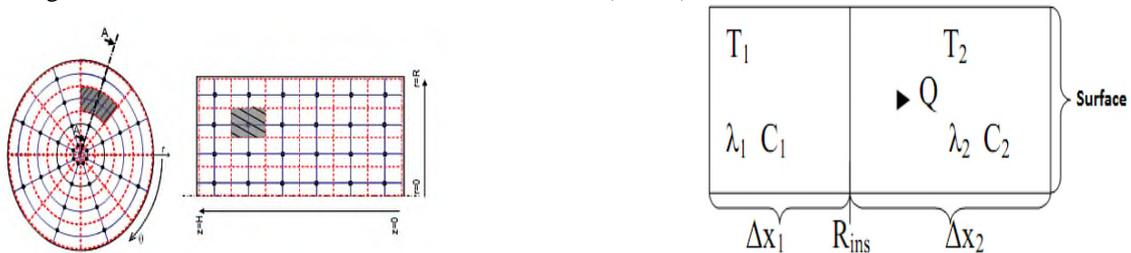
Figure 5 : (a).droite : Maillage par différences finies du stockage ; (b).gauche Dimension et propriétés thermiques de deux mailles adjacentes.
