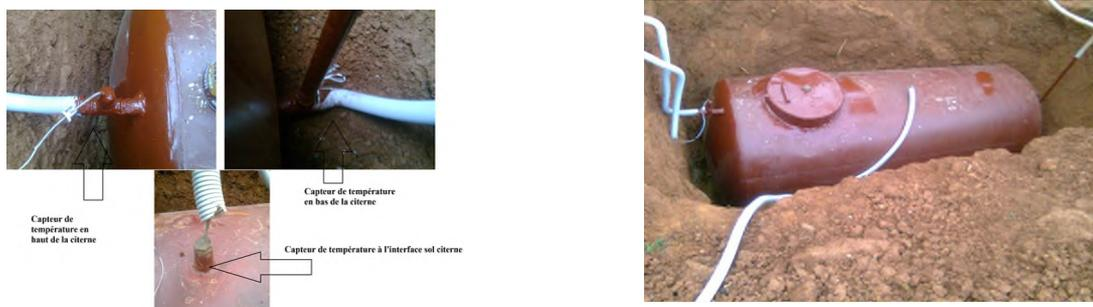
Figure 2 : (a).droite : Capteurs de température dans la citerne ; (b).gauche: Pose de la citerne dans la fouille.
