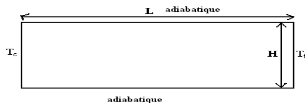
Figure 1 : Cavité allongée différentiellement chauffée ( H = 24 \text{ cm} , L = 1 \text{ m} , T_c = 303,5 \text{ K} , T_f = 287,5 \text{ K} )
