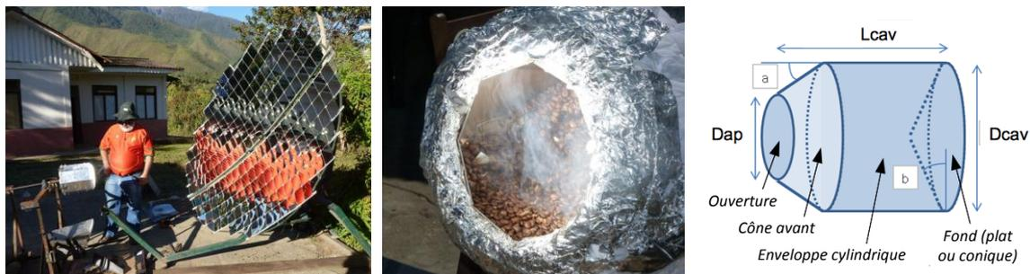
Figure 1 : gauche : Torréfacteur solaire lors d'une campagne de tests à Huyro, Pérou
