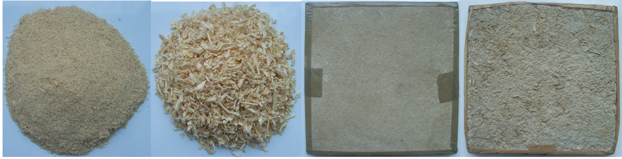
Figure 1 : aspect général respectivement de la sciure de bois, copeaux de bois, échantillon allégé avec 8% de la sciure et échantillon allégé avec 8% des copeaux.
