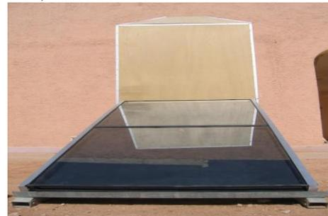
Figure 2 : le séchoir solaire indirect.
