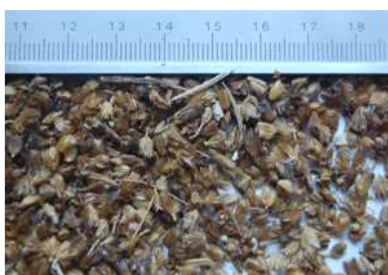
Figure 1 : Photo de déchets de mil utilisés comme matériau isolant
