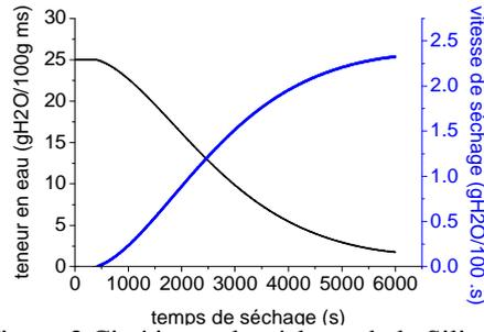
Figure 3 Cinétiques de séchage de la Silice
