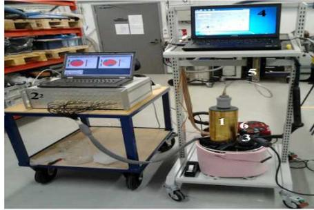
Figure 1 Dispositif expérimental du séchoir convectif ; Le dispositif est constitué d'une chambre de séchage (1), d'un système de tomographie de capacitance électrique (2), d'un pistolet à air chaud (3), d'un micro-ordinateur enregistrant les valeurs de températures détectées par l'ensemble des thermocouples installés (4), d'un contrôleur de débit volumique d'air sortant de la chambre de séchage (5), et d'un aspirateur (6).
