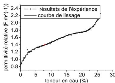
Figure 2 Courbe d'étalonnage de la teneur en eau.
