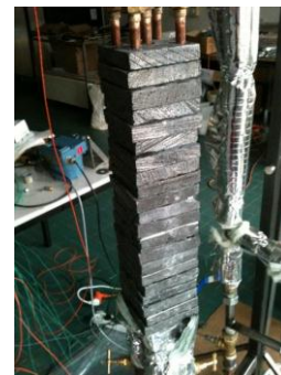
Figure 5 : Photo de l'échangeur contenant les plaques de matériau composite traversées par cinq tubes.
