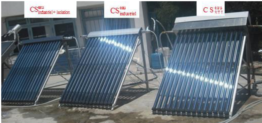
Figure 9 : Dispositif expérimental des trois systèmes
