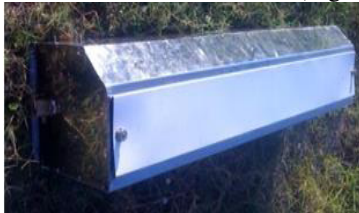
Figure 6 : Photo de la plaque de couverture de l'enceinte
