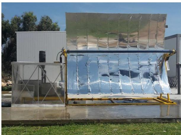
Figure 1: Prototype de concentrateur solaire -cylindro-parabolique.
