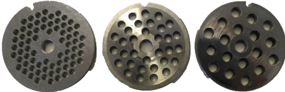
Figure 3: exemple de crible du broyeur
