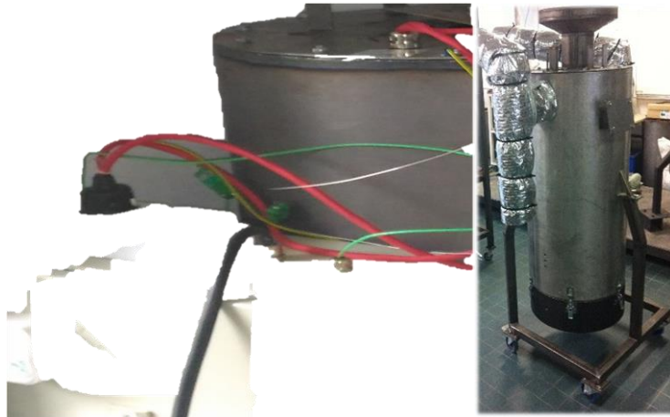
Figure 7: pyrolyseur (à gauche) et pyro-gazogène (à droite)
