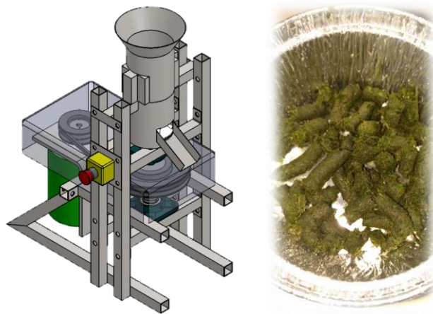
Figure 5: presse à granulé et exemple de granulés d'herbe
