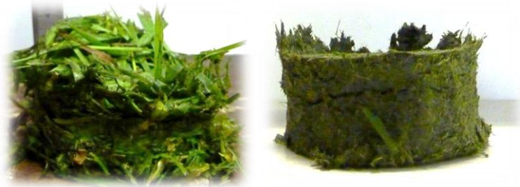
Figure 8 : Essais de mise en forme de palet : à droite sans broyage, à gauche avec broyage préalable
