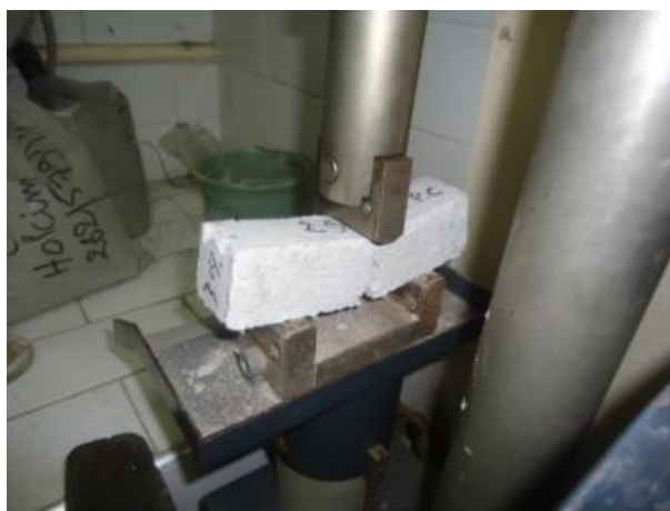
Figure 6 : mode de rupture des briques par essai de flexion.
