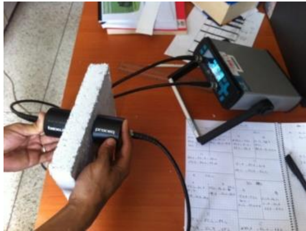
Figure 4 : Mesure de la vitesse du son d'une brique de papier.
