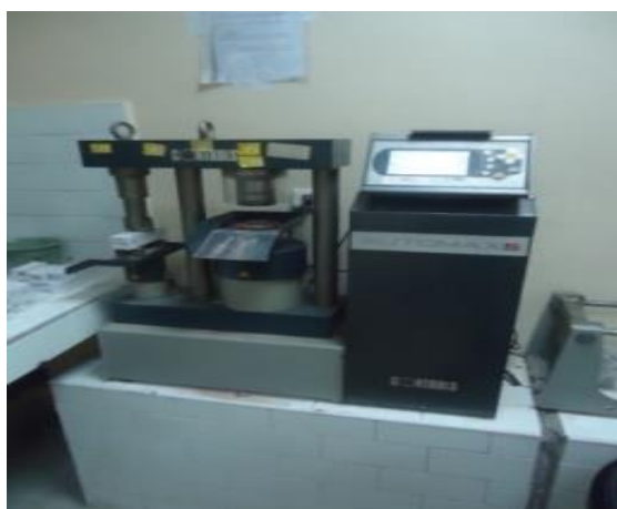
Figure 3 : Appareil CONTROLS AUTOMAX5 pour essais mécaniques résistance à la flexion et à la compression.
