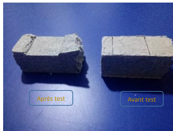
Figure 8 : Comportement des briques de papier soumises à l'essai de compression sur une surface de 4x4cm 2 .
