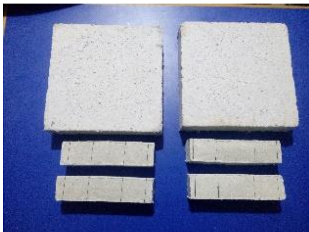
Figure 2 : Briques de papier confectionnées de dimension 20 \times 20 \times 4,5 \text{ cm}^3 et 4 \times 4 \times 16 \text{ cm}^3 .
