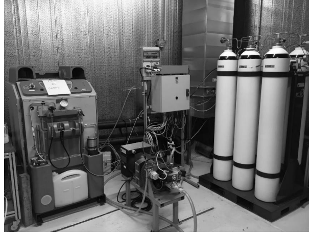
Figure 2 : Photographie du banc expérimental de stockage de l'énergie électrique par compression d'air.
