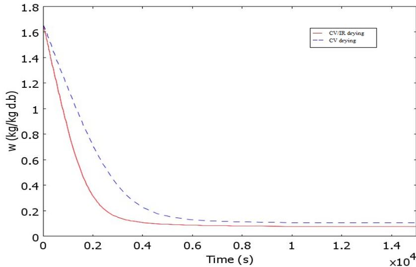
Figure 1 : Average moisture content variations versus time ( $T_a = 60\text{ }^\circ\text{C}$ ,  $RH=23\%$ ,  $P_{IR}=800\text{W/m}^2$ )
